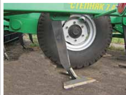
Стрельчатые плоскорежущие лапы и винтовые ребристо-планчатые катки культиватора «Степняк-7,4» создают условия для сохранения влаги.
