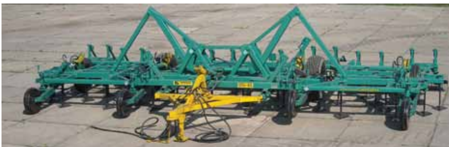
Орудие почвообрабатывающее ОПО-8,5 в агрегате с тракторами класса 5 оптимально подойдет для мелкой основной обработки почвы.
