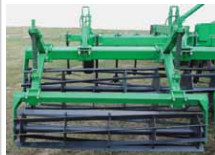
Стрельчатые плоскорежущие лапы и винтовые ребристо-планчатые катки культиватора «Степняк-7,4» создают условия для сохранения влаги.
