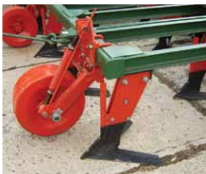
Универсальность КПИР-7,2 обеспечивают 19 плоскорежущих лап и 4 секции батарей игольчато-ножевых дисков и катков.
